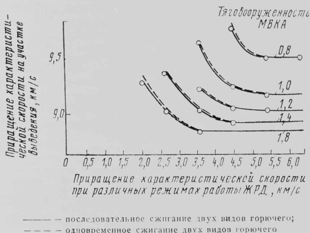
Рис. 3. Приращение характеристической скорости на участке выведения для одноступенчатого МВКА SSTO—НТО, оснащенного ЖРД с двумя степенями расширения и двумя видами горючего
